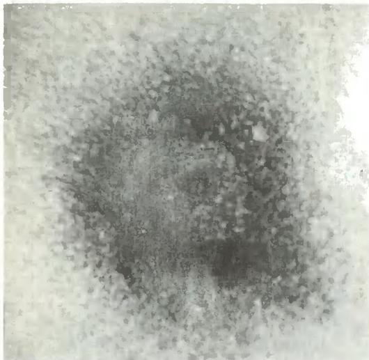
Рентгеновская микрофотография плазмы, полученной при облучении толокостенной стеклянной мишени диаметром 140 мкм и толщиной 1,2 мкм, наполненной газообразным дейтерием, сжатом под давлением 35 атм. Наблюдается сжатое ядро плазмы. Степень объемного сжатия порядка  $10^3$ .
