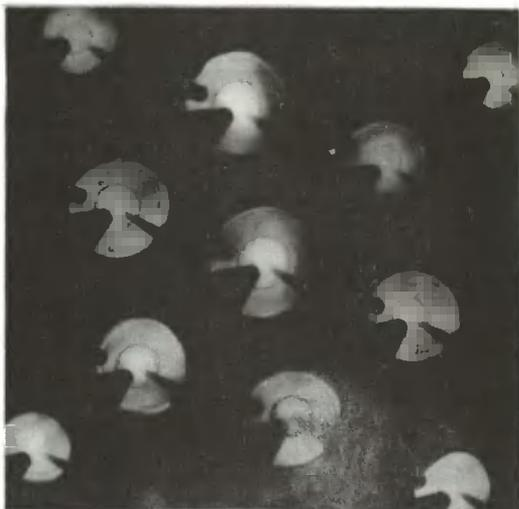
Многокадровая теневая фотография сферически симметричной ударной волны, образующейся в остаточном газе при расширении плазмы, нагреваемой лазерным излучением с энергией 1 кДж. Скорость съемки —  $5 \cdot 10^7$  с<sup>-1</sup>, время экспозиции — 1 нс. Показан процесс развития фронта ударной волны, распространяющейся со скоростью, превышающей  $10^5$  м/с.
